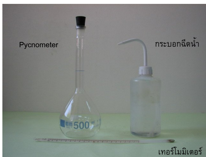
รูปที่ 1 Pycnometer แบบ Volumetric Flask, เทอร์โมมิเตอร์ และกระบอกจืดน้ำ
