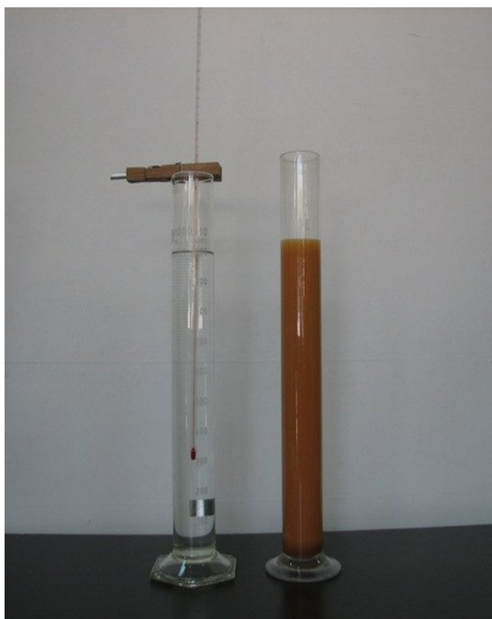
รูปที่ 3 การใช้ไฮโดรมิเตอร์วัดค่าเพื่อหา ขนาดเม็ดดิน
